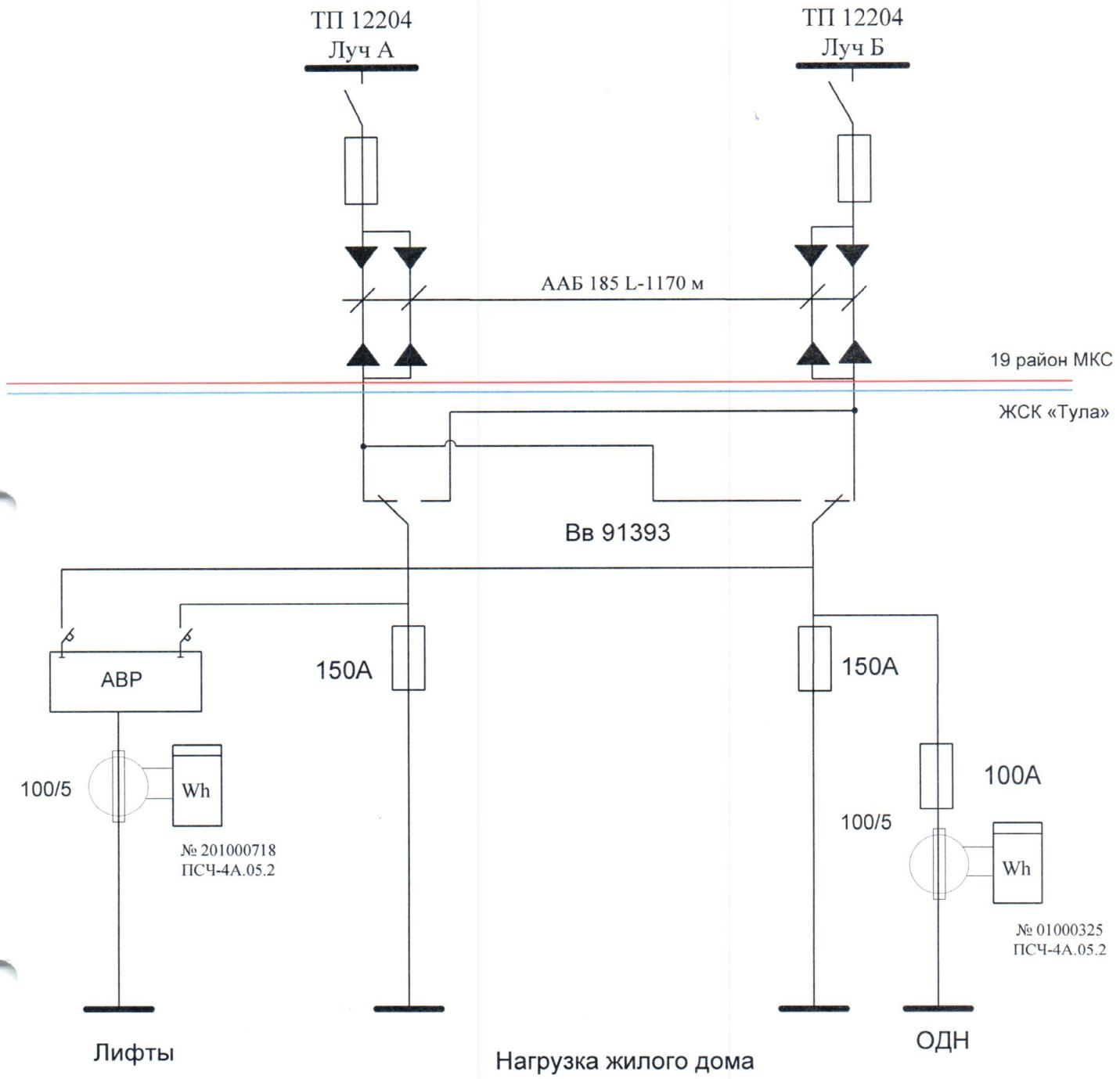
Примечание: В схеме указываются номера счетчиков, параметры измерительных трансформаторов, границы балансовой принадлежности (красный цвет) и эксплуатационной ответственности (синий цвет). Граница балансовой принадлежности и эксплуатационной ответственности субабоненто указывается зелёным цветом.
