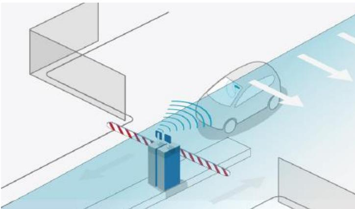
По возможности, располагайте наклейку со стороны автомобиля, находящейся ближе к считывателю. В случае установки считывателя на высокой мачте/столбе следует наклеивать метку в верхней части лобового стекла. И наоборот, если считыватель установлен на
